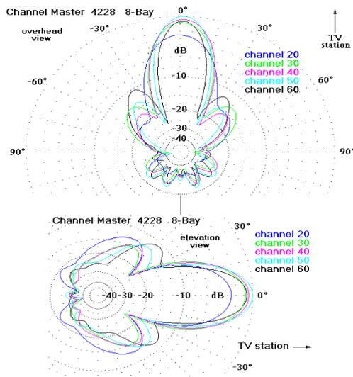
FIGURE 3: TYPICAL OUTDOOR TV ANTENNA PATTERN.
